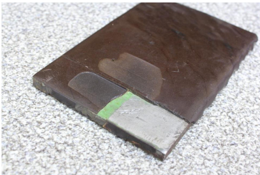
Рис.2.Сегмент стальной пластины с нанесённым компаундным покрытием толщиной от 2,0 до 3,0 мм.
