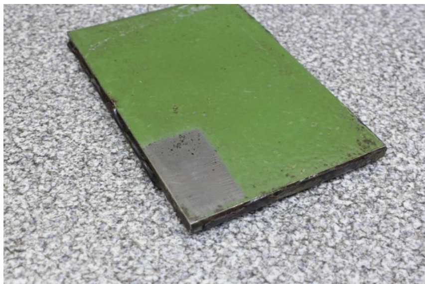
Рис.1. Сегмент стальной пластины с нанесённым лакокрасочным покрытием толщиной 0,5 мм.
