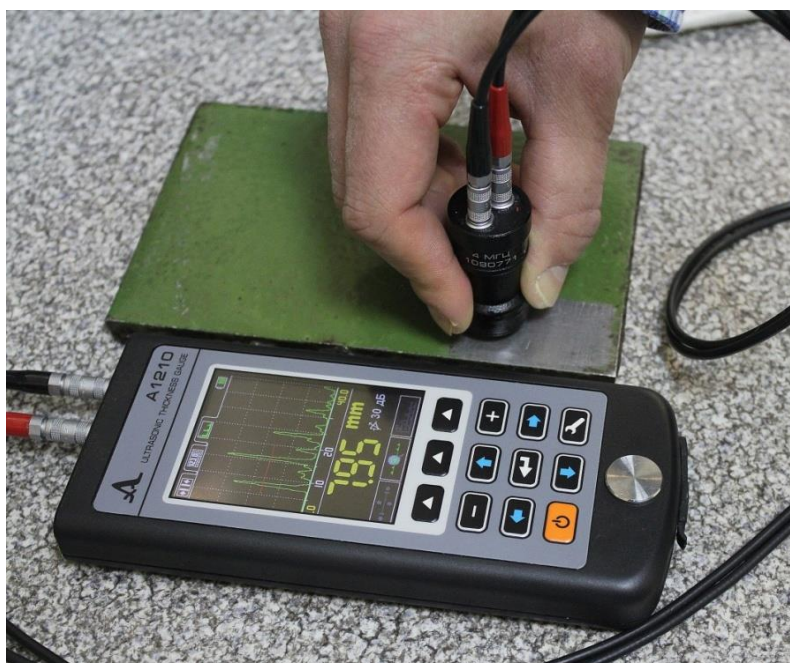
Рис.3.Проведение измерения толщины стальной пластины в местах с удалённым покрытием в режиме А-СКАН.
