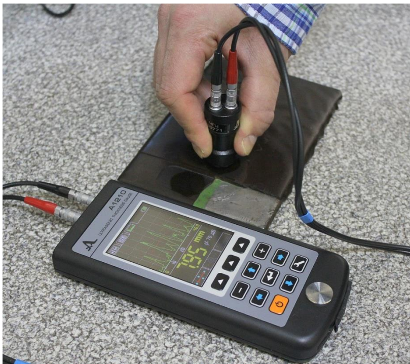
Рис.5.Проведение измерения толщины стальной пластины через компаундное покрытие толщиной 3 мм в режиме А-СКАН.
