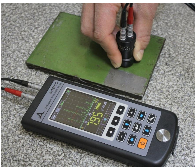
Рис.4.Проведение измерения толщины стальной пластины через лакокрасочное покрытие в режиме А-СКАН.
