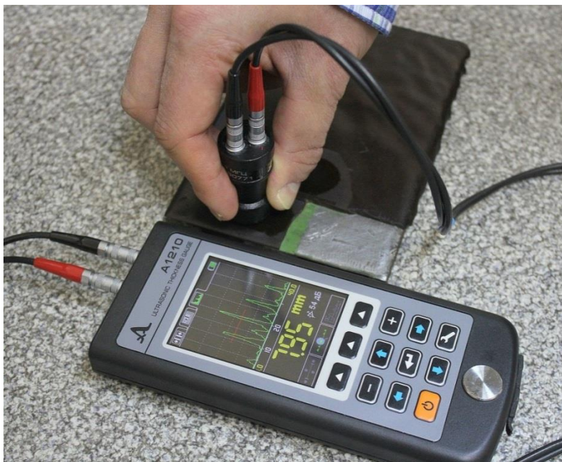
Рис.5.Проведение измерения толщины стальной пластины через компаундное покрытие толщиной 2 мм в режиме А-СКАН.
